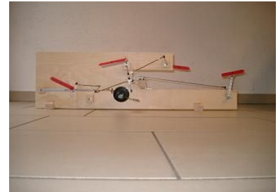
Bild 1: Steigflug einleiten (mit maximalem Auftrieb)
