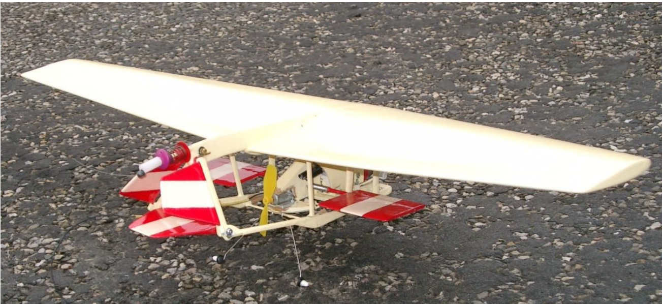
Bilderklärung: die am hinteren Teil des Flügels angebrachte Federkonstruktion ermöglicht das im Flug RC gesteuerte Modell vom dynamischen Flug in den Fallflug umzustellen (durch verschieben vom Motor, resp. des Kabinenteils).
