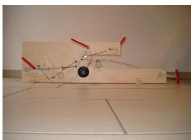
Bild 8: Fallflug mit aufgestellten Klappen um die Bauchlage sicherzustellen
